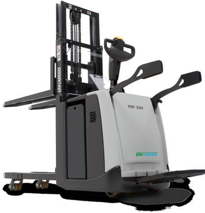
Doppelstock-Stapler mit Plattform geeignet für die Bereiche Laden / Entladen, „Cross-Docking“ und den internen Transport sowie gelegentliches Kommissionieren. Standardmäßig ausgerüstet mit Initialhub und klappbarer Fahrerstandplattform mit klappbaren Seitenschutzbügeln. Feste Fahrerstandplattform als Option erhältlich
