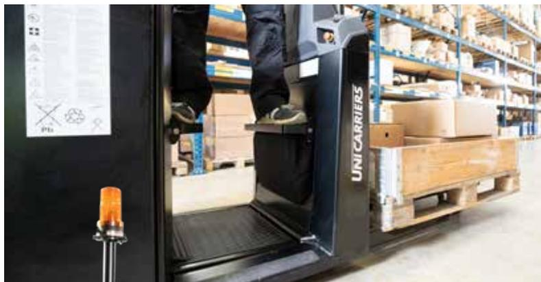
Staplers gesteuert werden, so dass der Bediener den Stapler bewegen kann, während er nebenhergeht. Bei der Kommissionierung geht der Bediener oft durch den Stapler, während er Waren transportiert. Durch die schmale und niedrige Rückenlehne kann der Fahrer schnell und einfach durch das Fahrzeug gehen, ohne sich dabei die Ellbogen zu stoßen.
