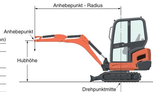
\* Die technischen Daten über den Arbeitsbereich der Maschine wurden mit dem Kubota Standard - Tieflöffel ermittelt, ohne Schnellwechseinrichtung.
